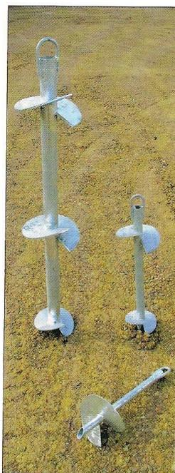
Une vis en acier galvanisée, dotée d'une verge creuse et biseautée, est mise en place par 2 plongeurs équipés d'une simple barre à mine (voir l'annexe n°8). Une fois en place, on y frappe une chaîne prolongée d'une bouée (ou directement le bout dans le cas de bateaux de plongée).
