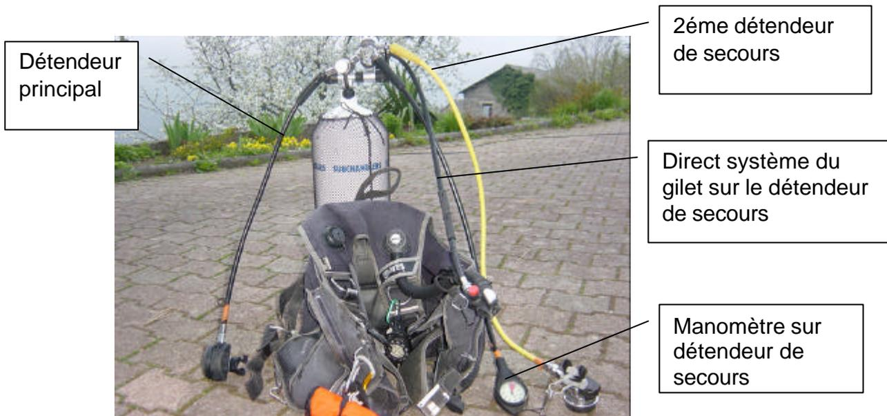
Les conditions d'eau froide impliquent l'utilisation de détendeurs spécifiques eau froide. Les détendeurs standards ne garantissant un fonctionnement optimal que jusqu'à 10° (norme EN 250).
